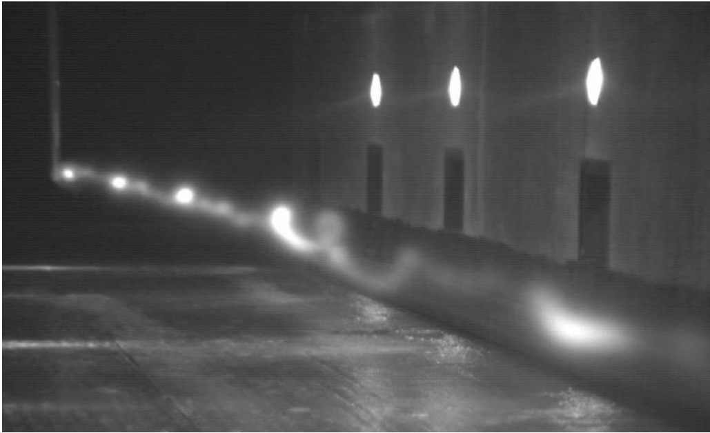
FIG. 1.6 – Visualisation d’un tourbillon de bout d’aile généré dans une soufflerie. \Gamma/\nu u = 40000 .
